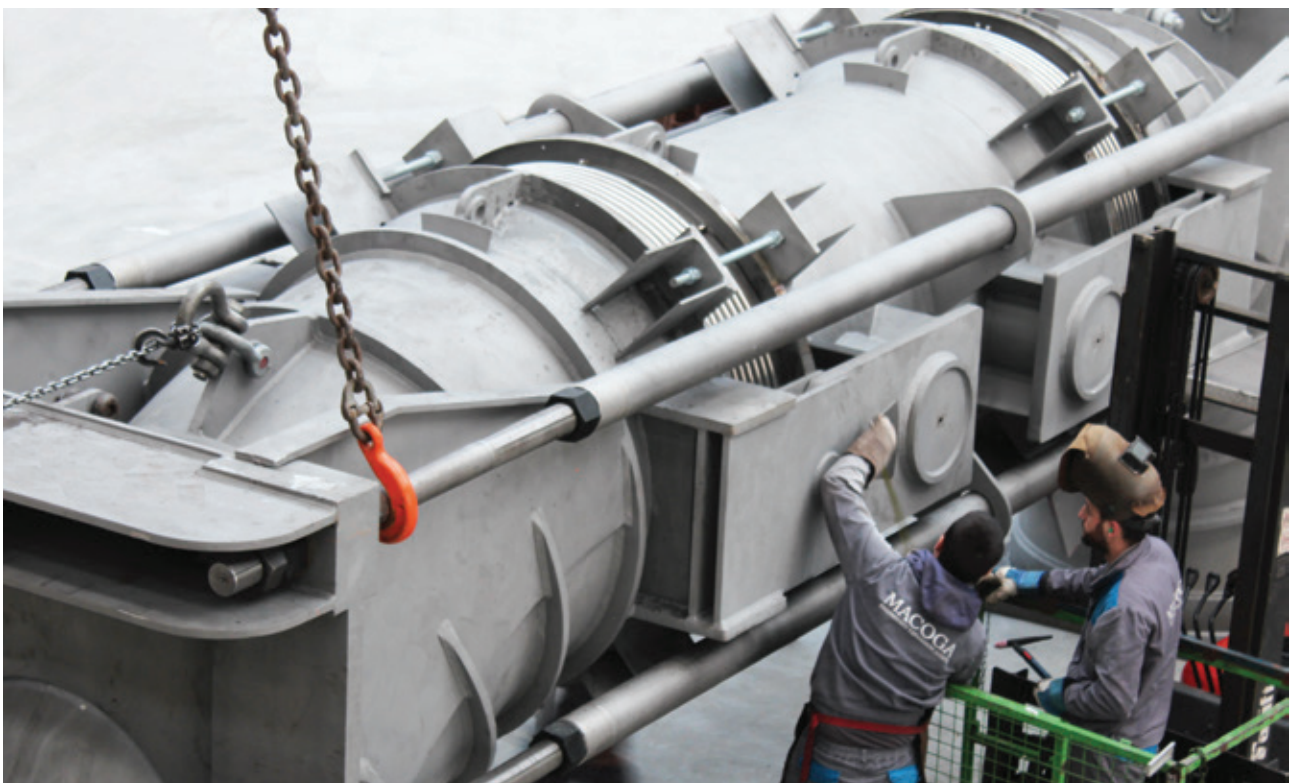
Линзовые компенсаторы M-Lens DN5900 для цементного завода
