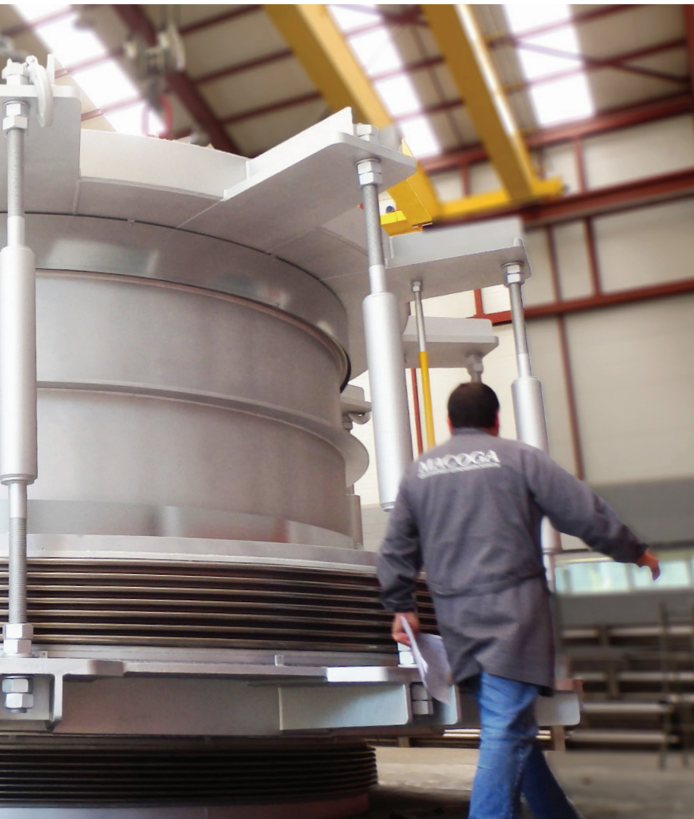
Линейный уравновешенный по давлению компенсатор MPB-I DN 4000 для атомной станции в Европе
