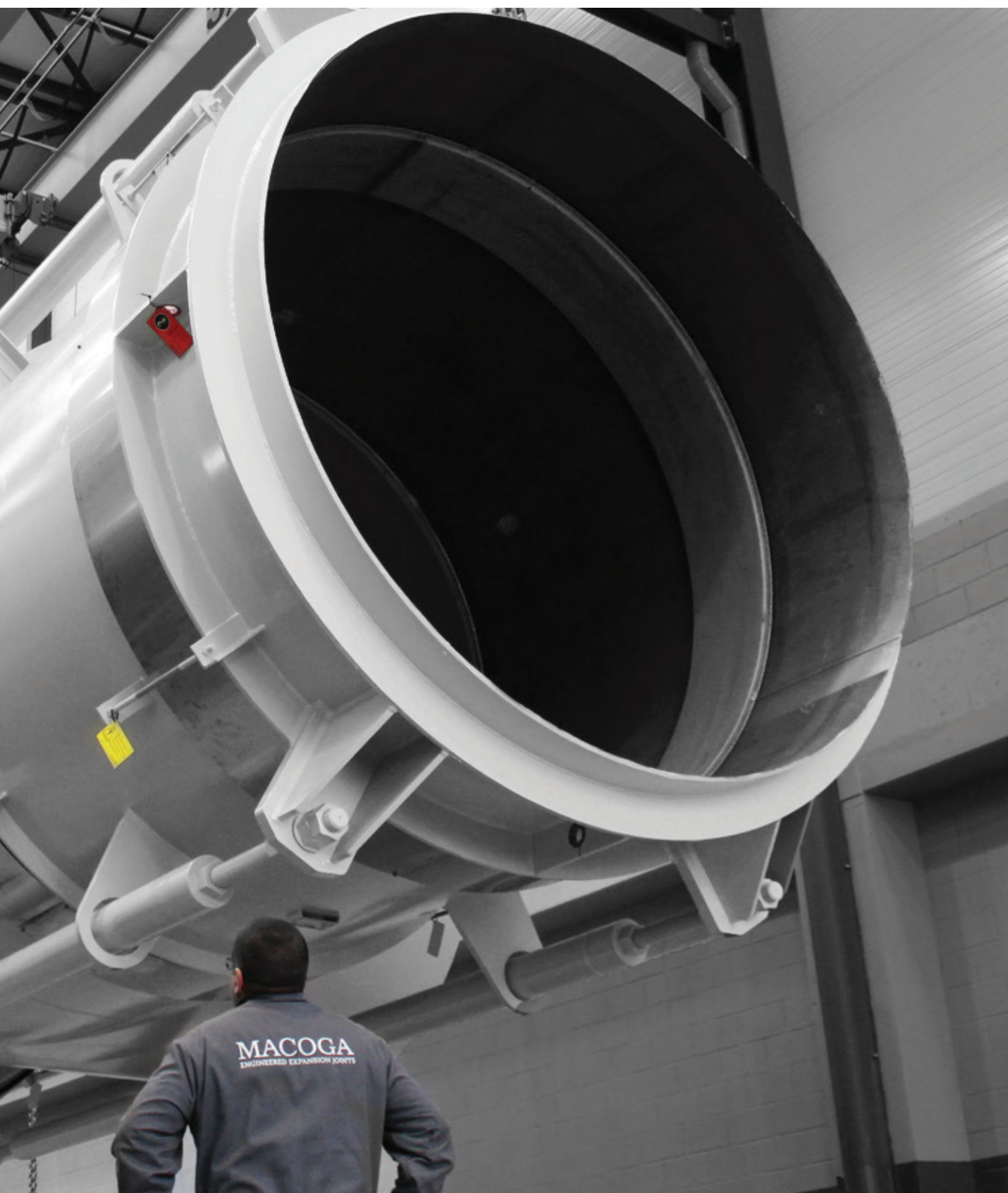
Уравновешенный по давлению компенсатор для отходов на энергетическом объекте в Великобритании
